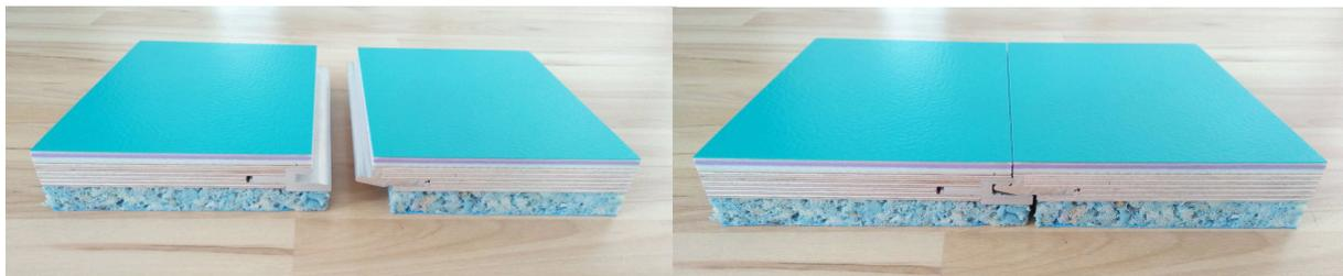
Die mobilen Systeme des SpeedCourt bestehen aus einer hochwertigen Sportbodenunterkonstruktion. Die 18mm Spezialsper Holz-Schicht nach EN 13986 – EN636-2S ist fest mit 18mm kaschierten Verbundschaum verknüpft. An den Längsseiten befinden sich Aluminium Speed-Lock Verbinder, die eine kraftschlüssige Verbindung der einzelnen Module untereinander ermöglichen. Die Größe des SpeedCourt kann wegen der Modularität individuell gestaltet werden.
