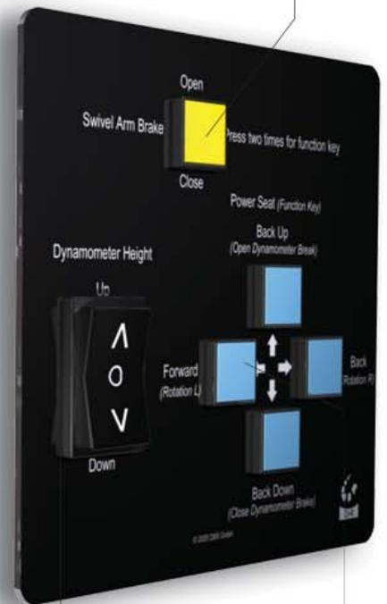
Steuern Sie von hier bequem und auf 0,5 Zentimeter genau die Höhe der Hubsäulen.
