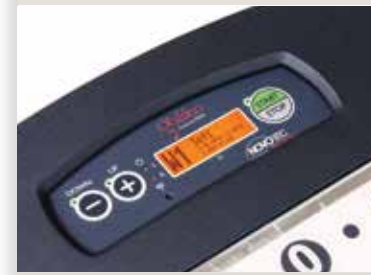
Integriertes Bedienteil mit Anzeige im Wobbel-Auswahlmodus
