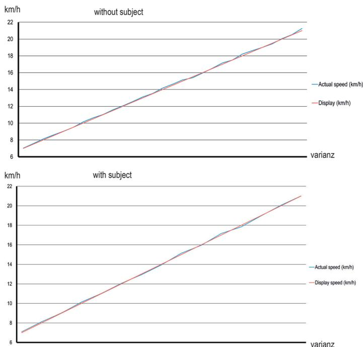
In dieser Tabelle ist die Genauigkeit der Geschwindigkeit des h/p/cosmos Laufbandes pulsar® 3p gemessen. In der ersten Spalte sehen Sie die Geschwindigkeit des Laufbandes ohne einen Probanden auf dem Laufband. In der Zweiten Spalte sehen Sie die tatsächliche Geschwindigkeit, mit welcher das h/p/cosmos pulsar 3p läuft. Die Differenz und der Prozentsatz sind in der nächsten Spalte zu finden. Diese Daten werden zur tatsächlichen Geschwindigkeit des Laufbandes, mit einem Probanden, verglichen.
