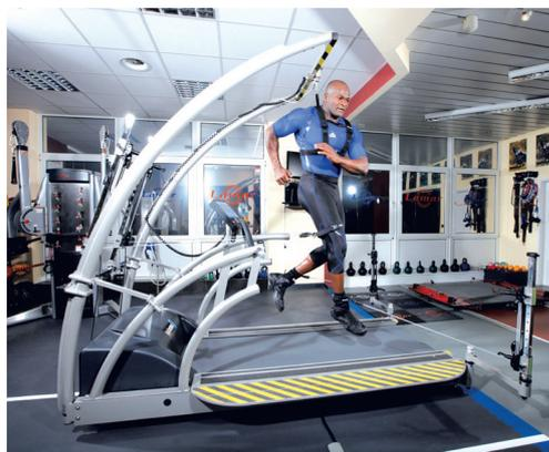
funktionales Training auf einem pulsar® 3p mit robowalk® expander, extra breiten Trittblechen und gekürztem Handlauf mit Zusatzgriff für Sprünge auf das Laufband und vom Laufband herunter
