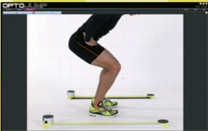
Graphische Bearbeitung eines Standbilds, mit Möglichkeit Winkel- und Längenmessungen zu erfassen.
