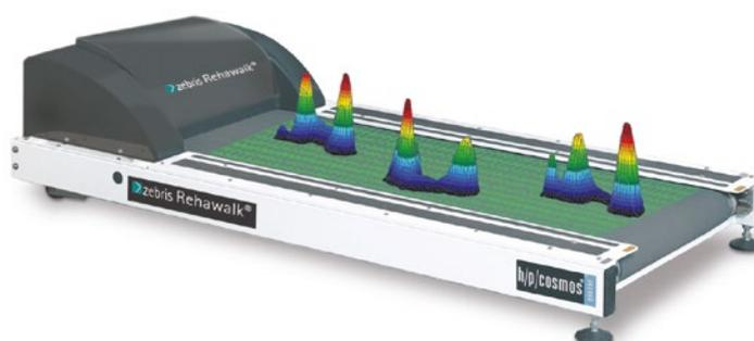
Unter der Lauffläche ist eine Messsensor-matrix mit mehreren tausend kalibrierten kapazitiven Drucksensoren installiert. Die Bewegung des Bandes wird kompensiert, so dass stabile Gang- und Abrollparameter analysiert werden.
