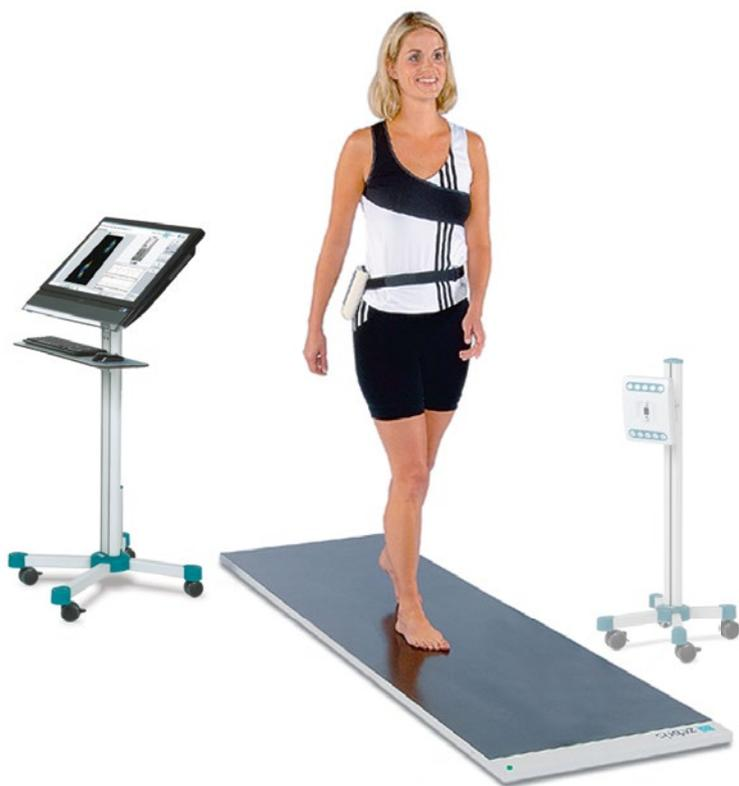
zebris FDM Messplattformen zur Stand- und Ganganalyse: 1,5 m - 6 m.
